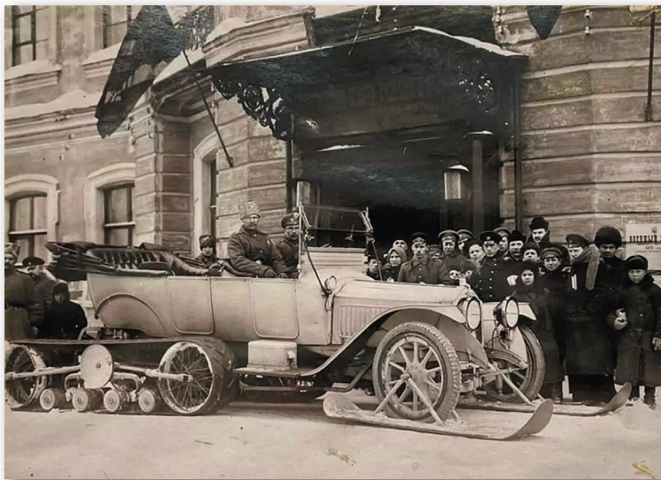
Limuzina Packard Twin-6 touring echipată cu Kégresse cale (sanie), din garajul țarului Nicolae al II-lea, confiscată de revoluționari
